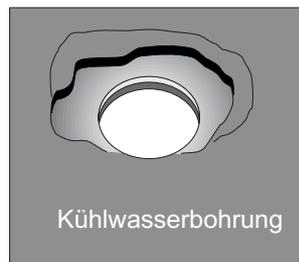
**I** Ablösung einer Weichstofflage durch ungeeignetes Frostschutzmittel im Kühlwasser
