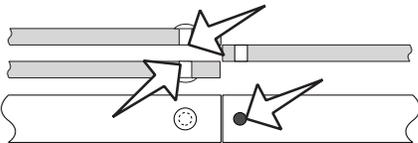
Failure due to tensile overloads
